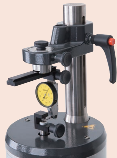
Wzorcowanie czujnika dźwigniowo-zębatego z dodatkowym wyposażeniem
