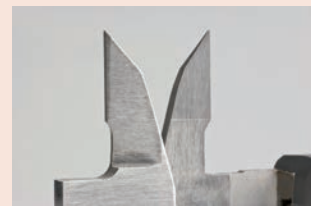
Powierzchnie pomiarowe szczęk z węglika spiekanego
