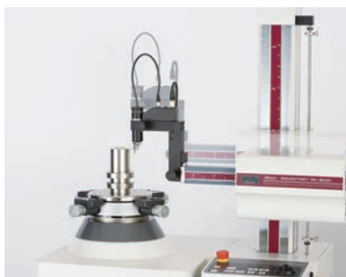
Pomiar/Analiza spiralna (RA-1600)
