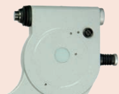
Śruba do regulacji mikrometru ± 5 μm
