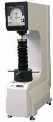
HR-210MR Twardościomierz Rockwella
