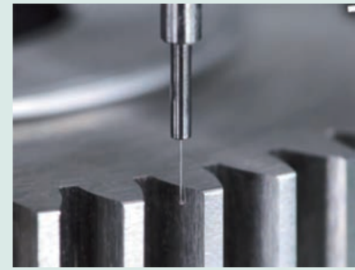
pomiar koła zębatego o module 0.8 z MPP-NANO
