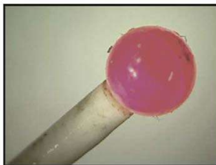
Zanieczyszczona końcówka trzpienia
