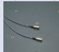
System kompensacji temperatury (czujniki temperatury)
