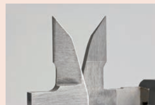
Powierzchnie pomiarowe szczęk z węgla spiekane
