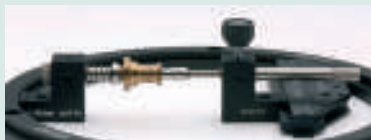
Mocowanie przedmiotu obrotowego w zaciskach kłowych.
